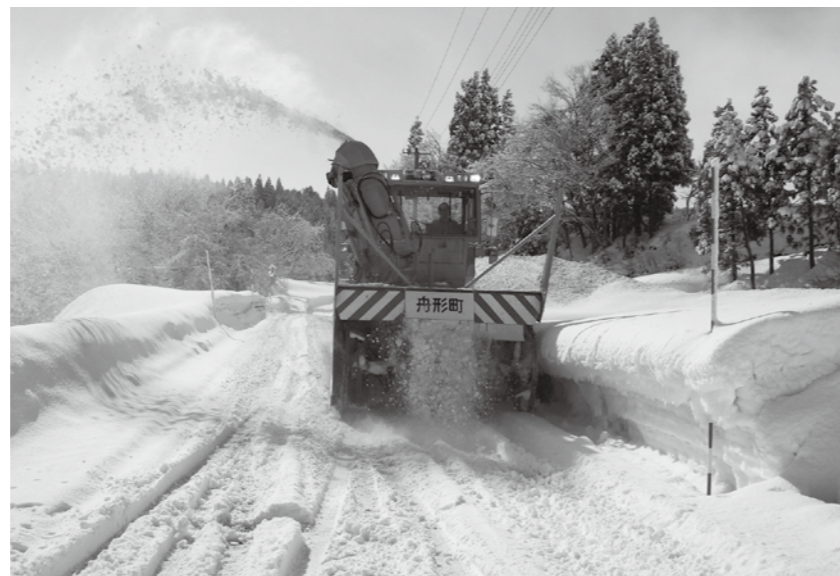
町民の暮らしのため稼働するロータリー除雪車
