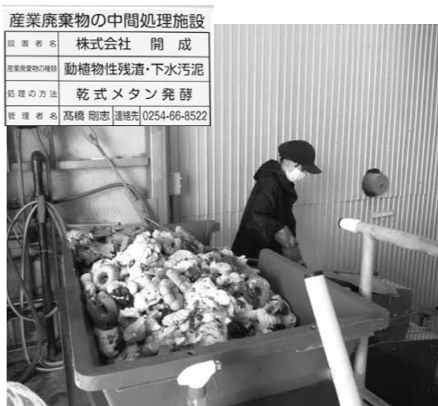
エネルギーの原料となる食品廃棄物の投入作業
