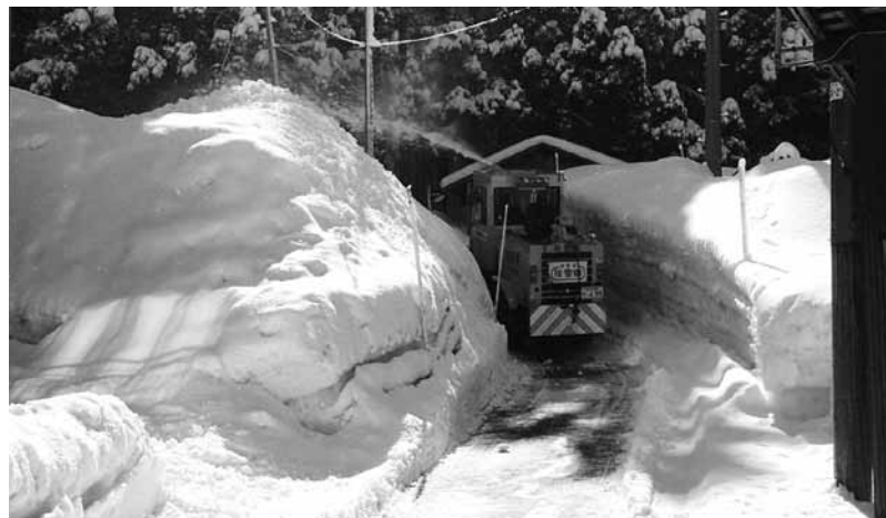
幅の狭い道路除雪で活躍する小型ロータリ除雪車
