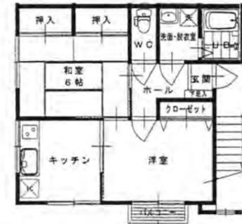
町では、西堀地区(舟形中学校前)に町営住宅1棟を建設中です。一階部分は車庫と物置で、2階部分は2DKの居住空間になっており、4世帯配置の建物となります(1世帯当たり延べ床面積1.2階併せて約85㎡)。
